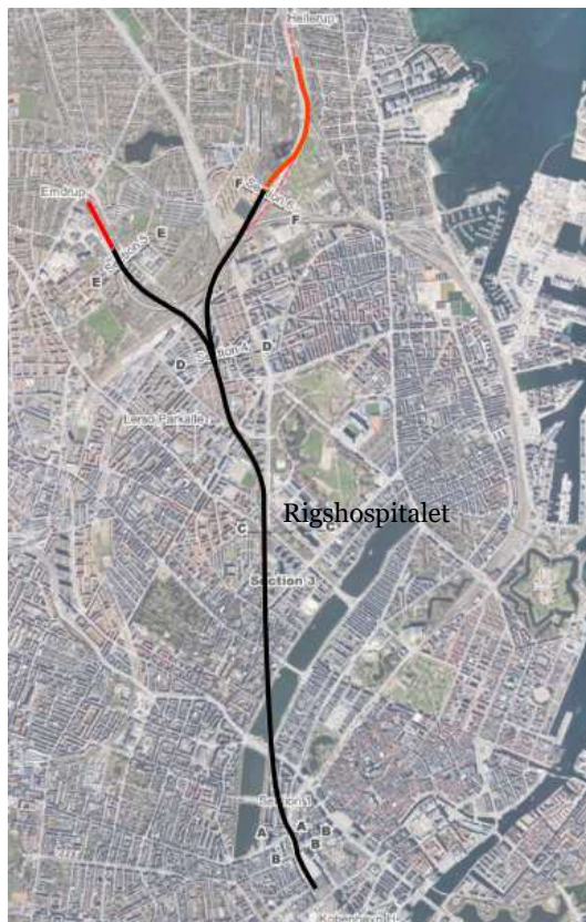
Figur 5.1 | En mulig linjeføring for en Eksprestunnel
